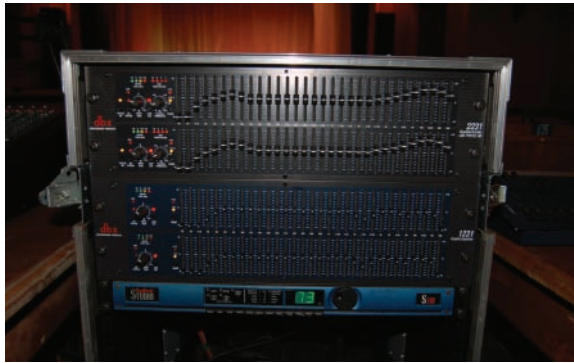
Приборы обработки звука. Сверху вниз: dbx 2231-EU (для FOH), dbx 1231-EU (для мониторов), голосовой процессор DigiTech S100
